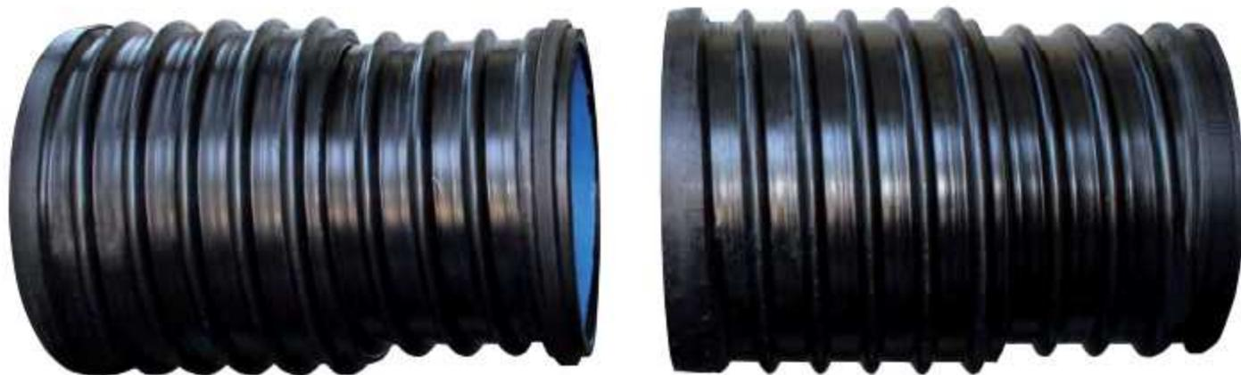
Entrambi gli elementi "maschio" e "femmina" hanno un profilo di parete strutturato di tipo spiralato, realizzato mediante avvolgimento ad elica, liscio internamente con costolature esterne rinforzate da una lamina sagomata ad omega di acciaio zincato classe DX51D + ZF/Z, conforme ai requisiti della norma UNI EN 10346 completamente incorporata nella parete del tubo.
